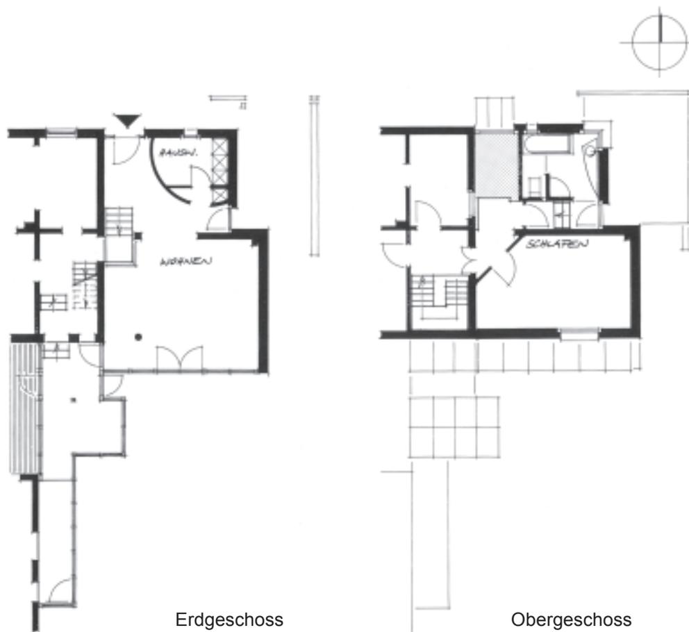
Abb. 7: - Grundrisse - Anbau eines neuen Eingangsbereiches an ein Doppelhaus der 60er Jahre [4]
